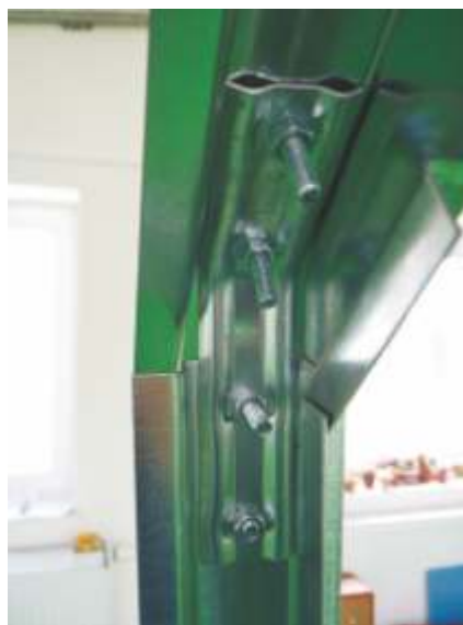
Montáž horního pravého rohového (střešního) sloupku (poz. 7, 9, 55 šrouby M6x25) Detailní pohled.
