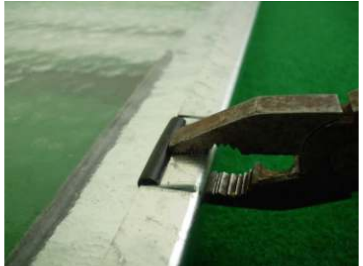
Pomocí kleští jemně přitlačíme příchytku (poz. 83-1)
