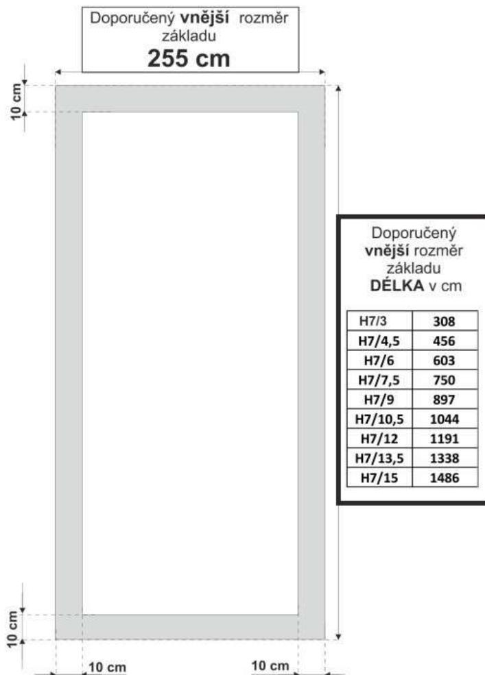
Doporučujeme pevné betonové základy ( lze použít i ztracené bednění). Pouze v případě rádného ukotvení skleníku k pevným základům lze dát plnou garanci za stabilitu skleníku dle statických výpočtů.
