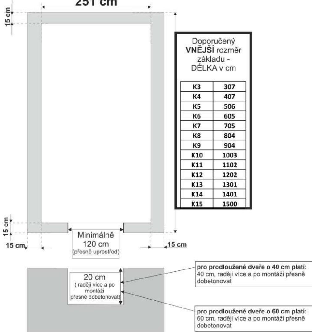
Doporučujeme pevné betonové základy (lze použít i ztracené bednění). Pouze v případě řádného ukojení skleníku k pevným základům lze dát plnou garanci za stabilitu skleníku dle statických výpočtů.
