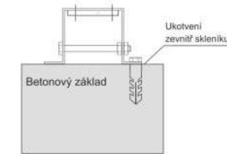
V základnách jsou připravené otvory k ukojení skleníku. Doporučujeme použít natloukací hmoždinky pr. 8x60mm
